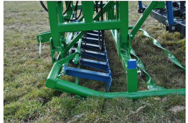
Verend mes voor intensieve bewerking (b.v. lostrekken van mestresten, gecombineerd met trillers voor optimale verspreiding van restmateriaal)
